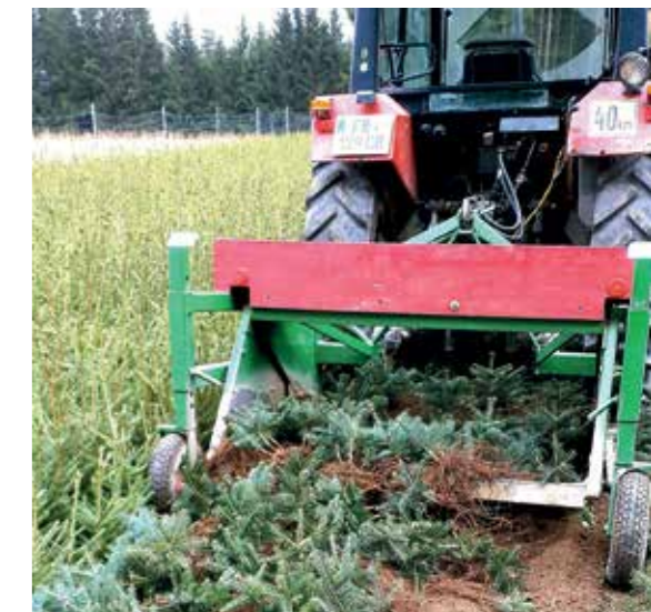
Schonende Rodung mittels Rüttelpflug.
