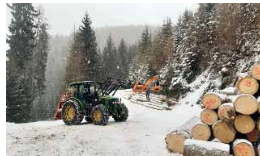
Die Kombination eines Traktor-Seilwindengespannes mit einer Rückzange erhöht die Flexibilität sowie die Einsatzmöglichkeit. Foto: Karl Fladl
