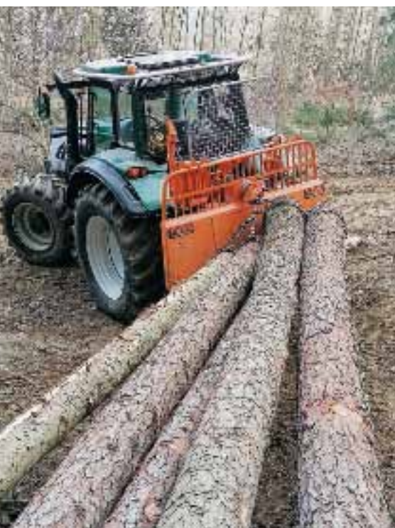
Das Verhältnis von Traktor und Seilwinde sollte ausgewogen sein. Foto: G. Hirtler
