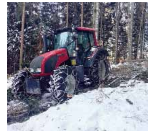
Die Frontgewichte am Traktor reduzieren das Aufbäumen.
