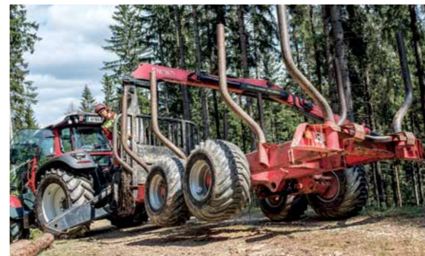
Vor allem bei leerem Krananhänger erhöhte Kippgefahr - auf korrekte Abstützung achten (Traktor leicht mit anheben).
