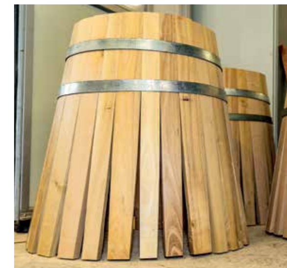
Jede „Fassdaube“ wird einzeln bearbeitet und zu einem „Reifrock“ zusammgebaut.
