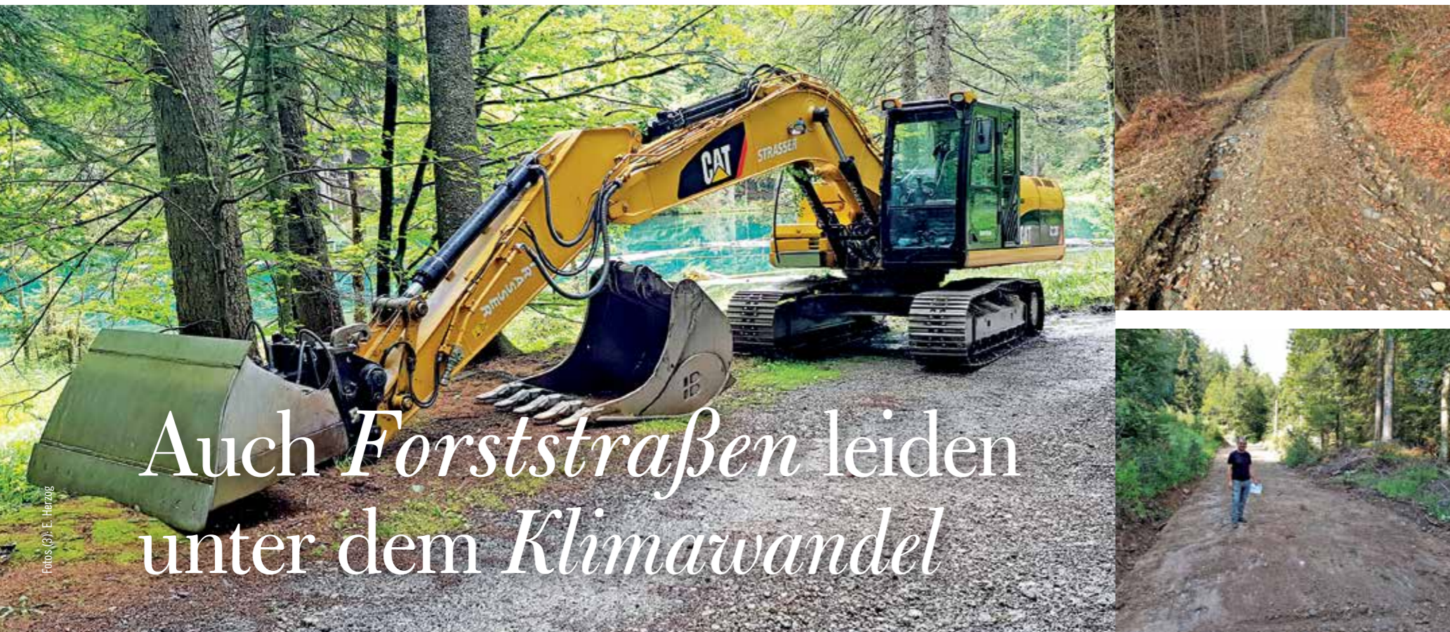
Bagger mit Böschungslöffel, bestens geeignet für die Herstellung des Spitzgrabens und zum Abziehen des Bewuchses von Fahrbahn und talseitigem Bankett.
