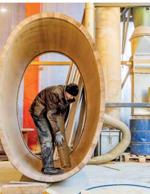
Fässer mit bis zu 5.000 Liter Fassungsvermögen werden von den Fassbindern in Handarbeit hergestellt.
