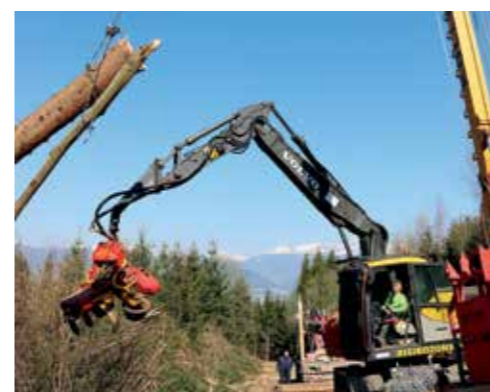
Für den Waldbesitzer gilt – unbedingt Interesse an der Arbeit zeigen. In der Flexibilität bietet der auf dem Bagger aufgebaute Prozessor unbestritten Vorteile.
