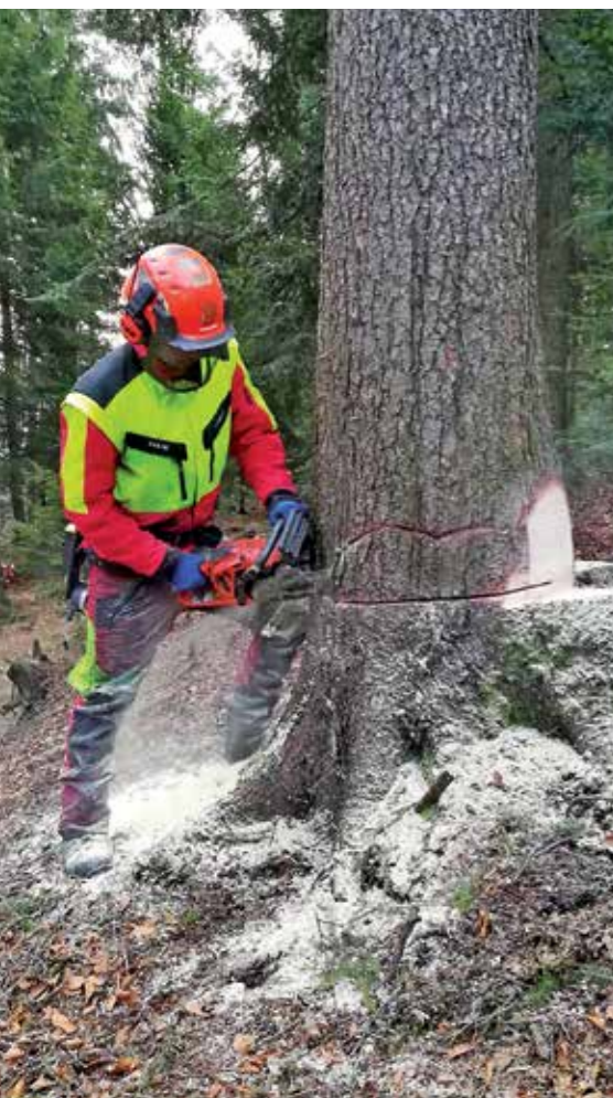
Abb. 1: Rücken gerade halten und Motorsäge beim Schneiden abstützen.
