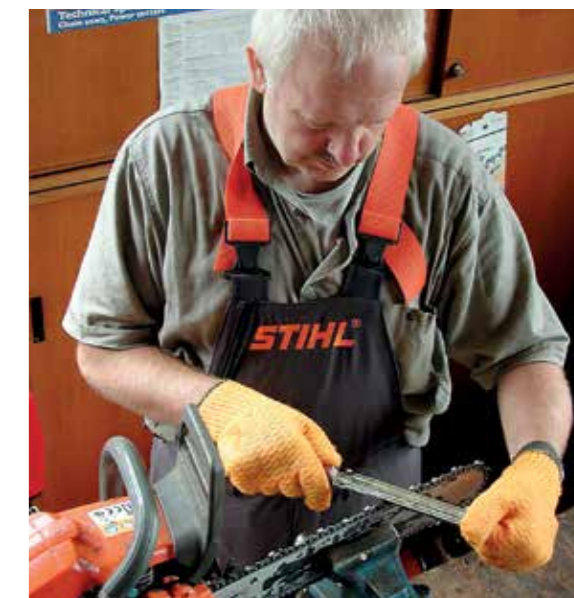
Kettenschärfen mit Rundfeile und Feillehre. Beim Schärfen im Wald wird die Motorsäge im Feilbock eingespannt oder in einem Schnitt eingeklemmt.
