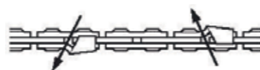
Abb. 2: Beim Schärfen wird die Feile von innen, von der offenen Seite des Zahndaches nach außen in Richtung der Seitenplatte geführt.
