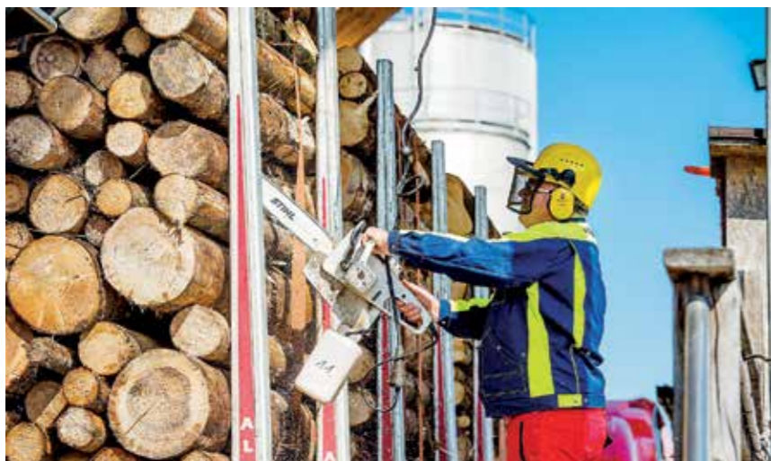
Die Spanprobenentnahme erfolgt im Zuge der Verwiegung der Ladung im Werk. Foto: Mike Ellis Photography
