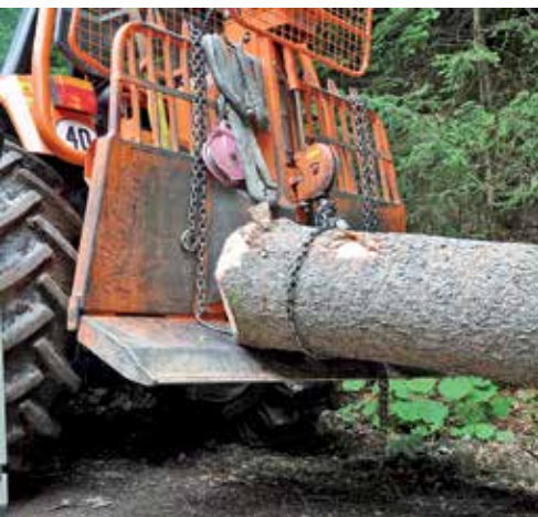
Die Traktorseilwinde ist das meist eingesetzte Rückegerät im Bauernwald. Im Stammverfahren sollte die Lastbildung bündig und „kopfhoch“ erfolgen. Fotos (3): FAST Ossiach
