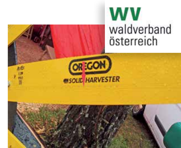
Die Sprühdüsen sind am Harvesterschwert gut zu erkennen (roter Pfeil).
