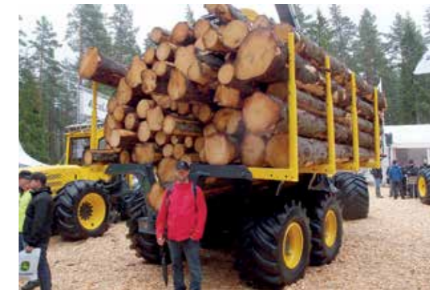
Ein Rungenkorb eines Forwarders mit etwa 40 Festmetern Inhalt.
