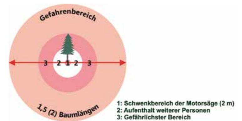
Abb. 2: Sicherheitsabstände bei der Schlägerungsvariante 2.
