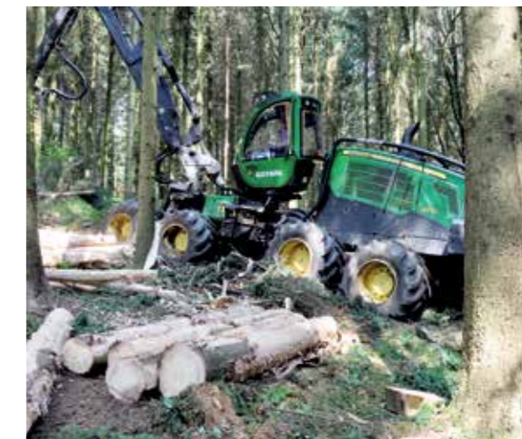
Harvester 1270G mit umgerüstetem H415 Aggregat von John Deere beim Entrinden und Ausformen von Sortimenten im Versuchsbestand.
