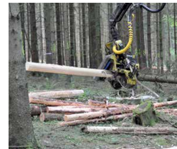
H415 Harvesteraggregat von John Deere beim Entrinden und Ausformen von Sortimenten im Versuchsbestand.
