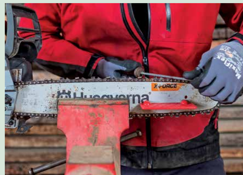
Kettenschärfen: Gut und regelmäßig gewartetes Arbeitsgerät ist Grundlage für die persönliche Arbeitssicherheit.
