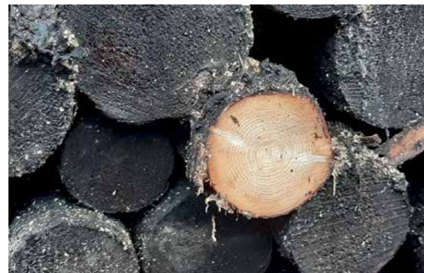
Der Probeanschnitt zeigt, dass die Qualität des Rundholzes im Nasslager erhalten werden konnte.
