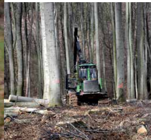
Beim Platzbedarf für die Erntemaschine ist auch auf ausreichend Abstand zum verbleibenden Bestand zu achten.
