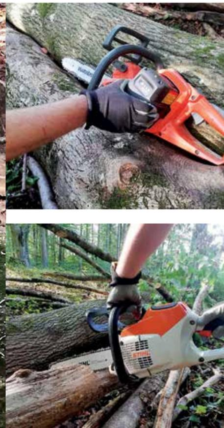
Bei der Husqvarna 535iXP wird der Akku seitlich eingesteckt. Eine Ansammlung von Wasser und Schmutz im Akkuschacht wird so vermieden. Durch das Verwenden von schmalen Sägeketten können hohe Schnittleistungen erreicht werden.
