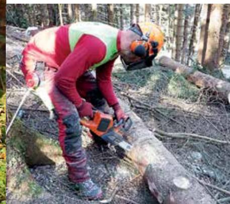
Die Messung der Lärmbelastung erfolgte direkt am Ohr der Bediener. Vor allem an langen Arbeitstagen stellt die Energieversorgung mit einer ausreichenden Anzahl an Akkus eine Herausforderung dar.
